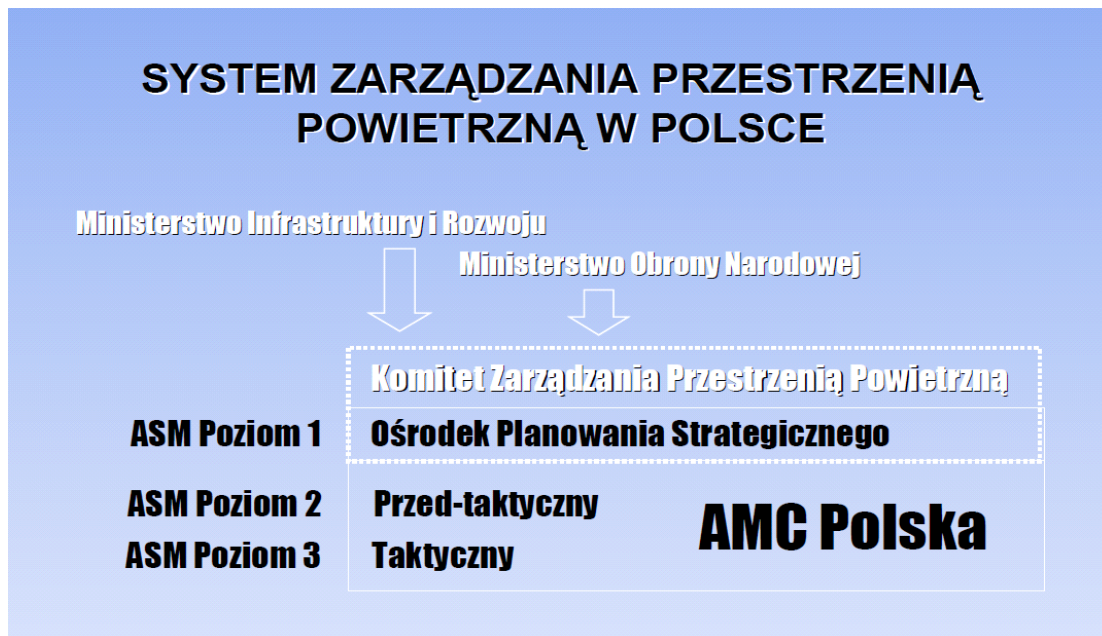
Rysunek 2. Schemat systemu zarządzania przestrzenią powietrzną w Polsce.
